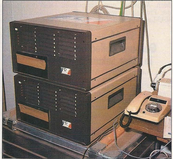
Im Keller befindet sich unscheinbar das Gedächtnis des ganzen COSS-Systems: zwei Festplattenlaufwerke mit insgesamt 40 MByte.
